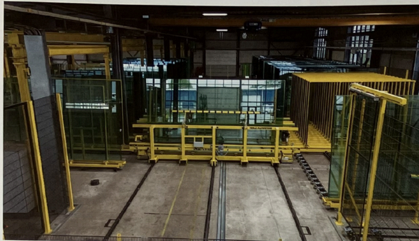
▲ Een Hegla RapidStore met automatische oplegrobot zorgt in Gildehaus voor het snel en efficiënt beladen van de drie snijtafels
