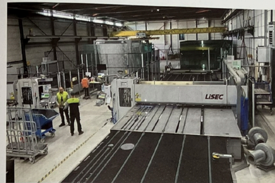
▲ In 2021 zijn bij Vandaglas in Emmen naast de bestaande snijtafel voor floatglas twee nieuwe LiSEC-snijtafels voor gelaagd glas geïnstalleerd.
