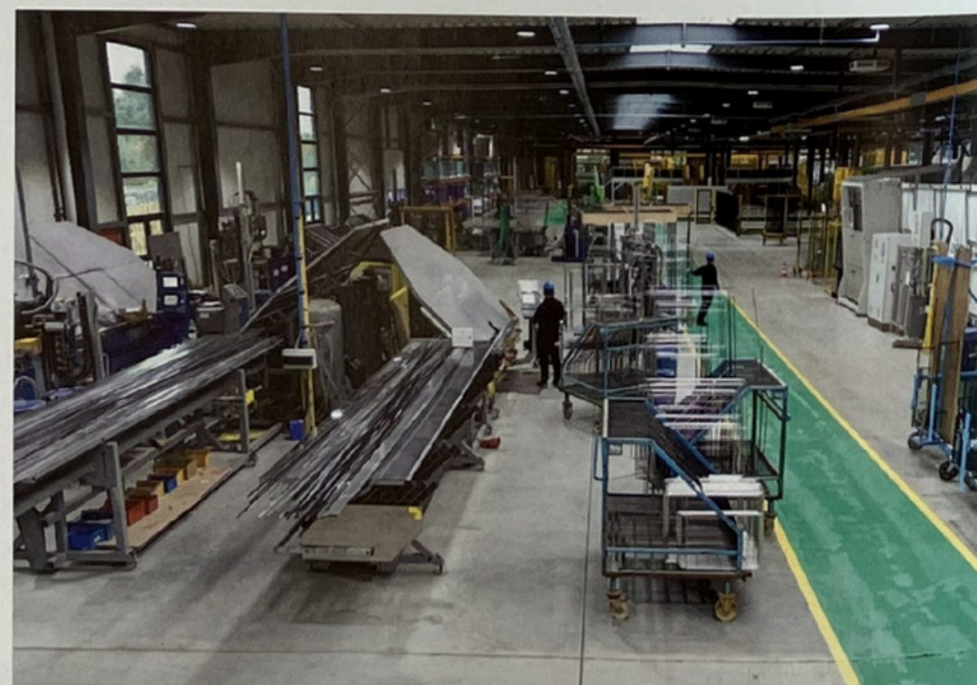
▲ Automatische straat bij Pilkington Gildehaus voor het buigen van aluminium afstandhouders. Het is goed te zien dat de productie in lijn is.
